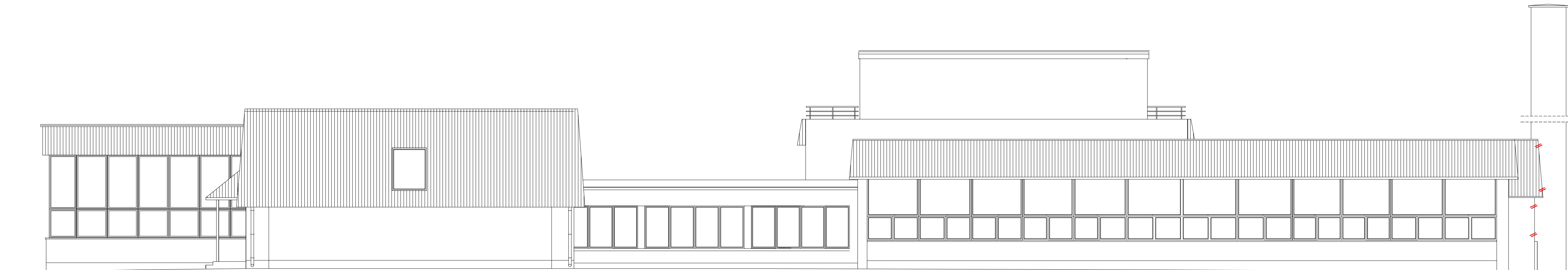
ELEWACJA PÓŁNOCNA PRZED ROZBUDOWĄ 1:100
